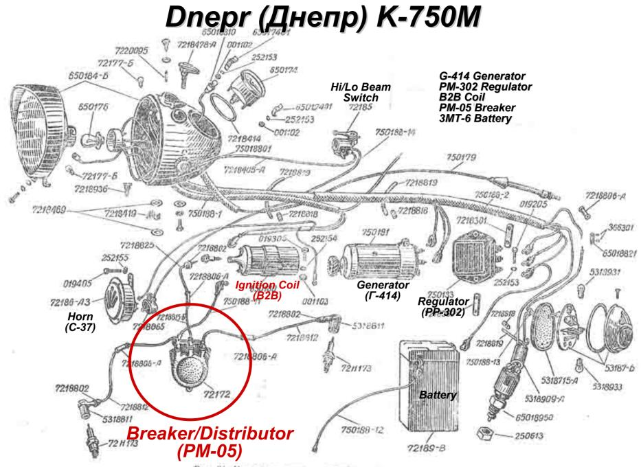
Рис. 34. Монтажная схема электрооборудовання мотоцикла:
